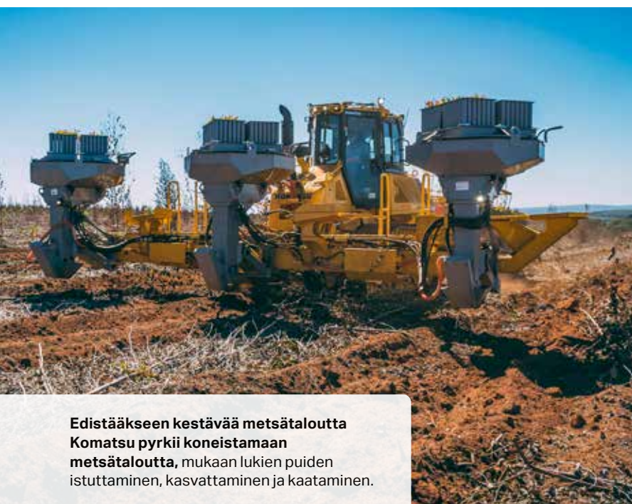
Uudet istutuskoneet ovat muuttaneet istutusprosessin manuaalisesta työstä paahlavassa helteessä koneelliseksi työksi, jossa istutetaan 900 puuta tunnissa poikkeuksellisen nopeasti ja tarkasti.
