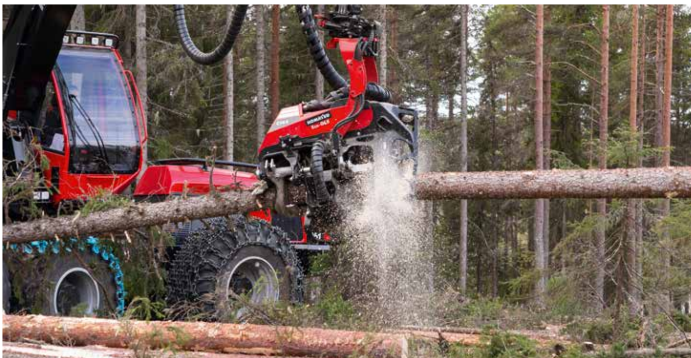
Uma corrente lubrificada por graxa reduz o impacto ambiental. Disponível como opcional para os cabeçotes Komatsu C93, C123, C124 e C144.
